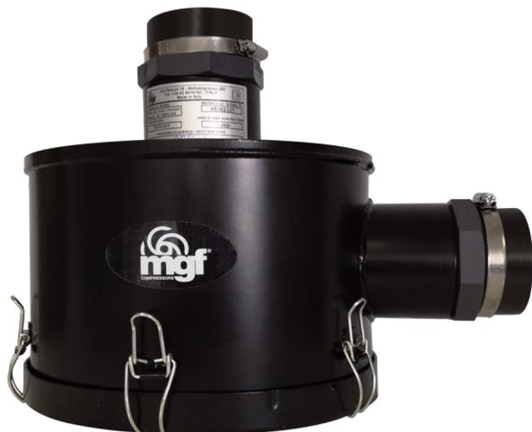
Kit filtrazione con elemento HEPA H14 per aspirazione odontoiatrica. Questo kit è utilizzabile per tutti i tipi di aspirazione odontoiatrica ed è installabile sia a valle dello scarico dell'aria esausta (aspirazione umida), sia a monte (aspirazione a secco). E' di facile installazione e manutenzione. Il kit include anche la raccorderia necessaria ad adattare il filtro a tubazioni di diametro 30 e 40 mm, sia in entrata che in uscita dal filtro.
